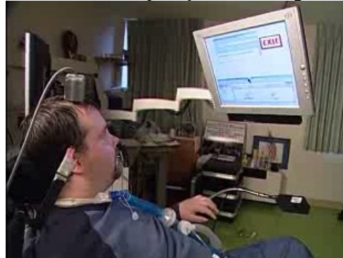
Figura 6. Roberto, tetrapléjico, interactúa con la computadora a través de la sustitución sensorial. El programa informático recibe las señales del casco y a partir de las variaciones de actividad de las neuronas el computador mueve el cursor en la pantalla hacia la dirección deseada igual que lo habría movido usando las manos.
