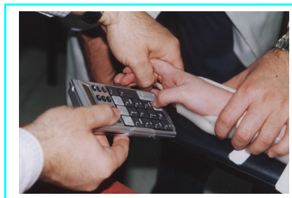
Figura 4.- Inicialmente se comprobó la acción de Marta con su dedo pulgar sobre las teclas del Teclado Numérico. Posteriormente se probaron férulas estandarizadas y se acabó acoplando el teclado numérico al reposabrazos de su silla de ruedas. Fotos: M a Luisa Salvador
